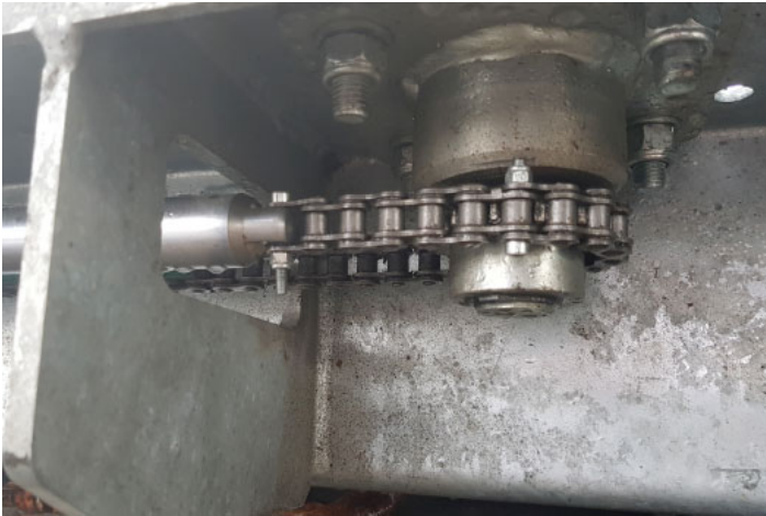
Деталь соединения между поршнем и цепью движения.
