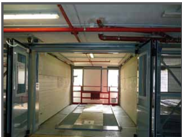
Рис. 1: Входной участок, контроль размещения автомобиля на платформе. Вход в зону хранения автомобилей защищен двумя раздвижными дверьми.
